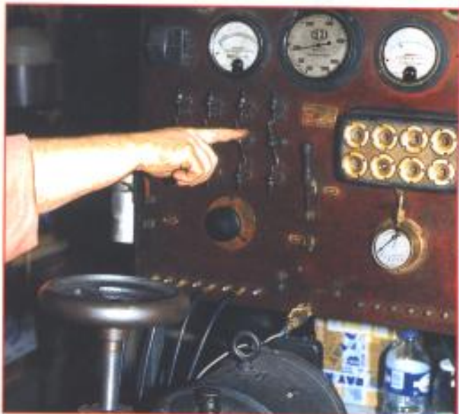
Durant sa réfection, la magnéto est vérifiée à tous les régimes sur des éclateurs.
